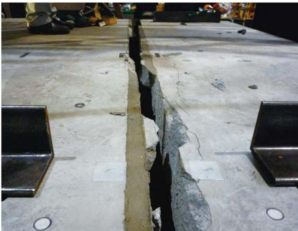
継手部の破壊状況
