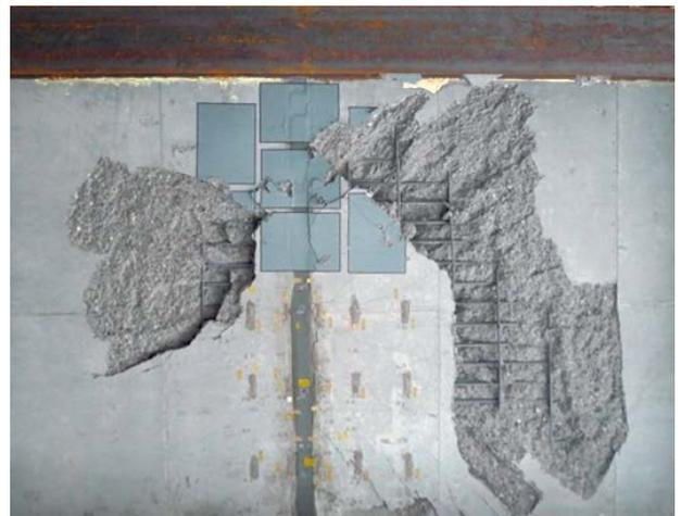
床版下面の破壊状況
